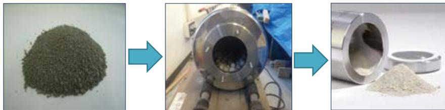
図1 ボールミルによる微粉末化
