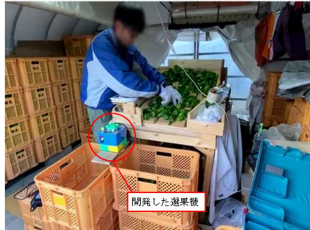
図 試作 4 号機によるピーマン選果の実証実験
