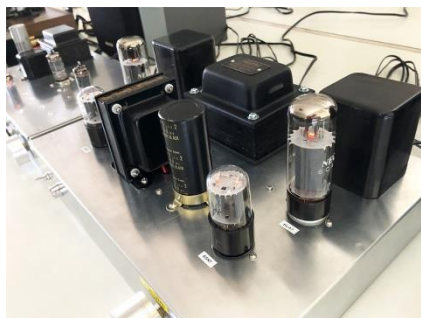
写真1 手持ちの部品で製作した真空管式ステレオアンプ
