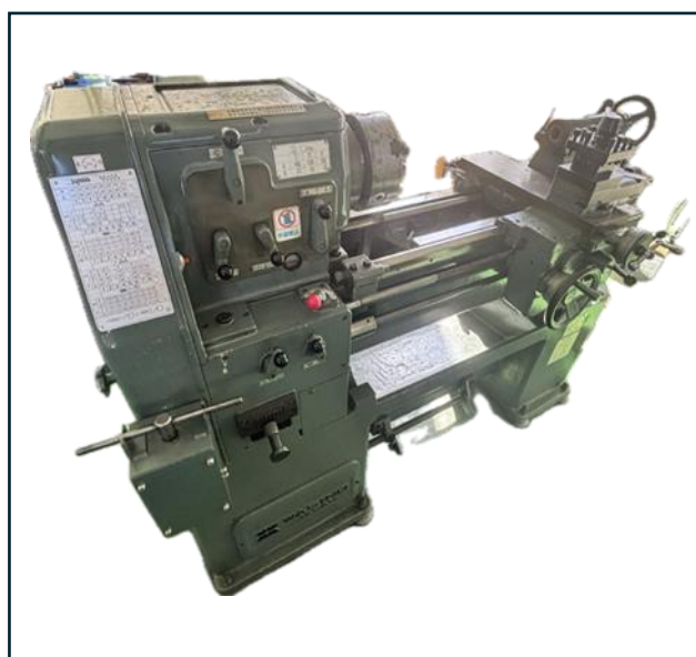
図 4. 使用旋盤：精密旋盤[LR-55A 型]
