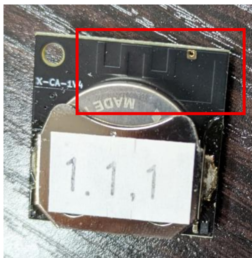
図 10 TWELITE ARIA の基板と基板アンテナ（赤枠部分）
