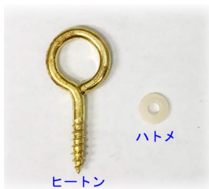
写真5 糸巻き部品の製作 [→ハトメ部分は微細な穴あけ加工が必要]
