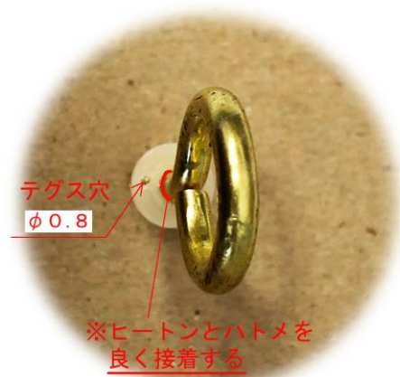
写真5 糸巻き部品の製作 [→ハトメ部分は微細な穴あけ加工が必要]
