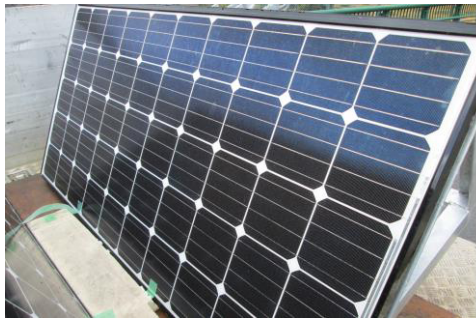
写真3 太陽電池パネル(212W)
