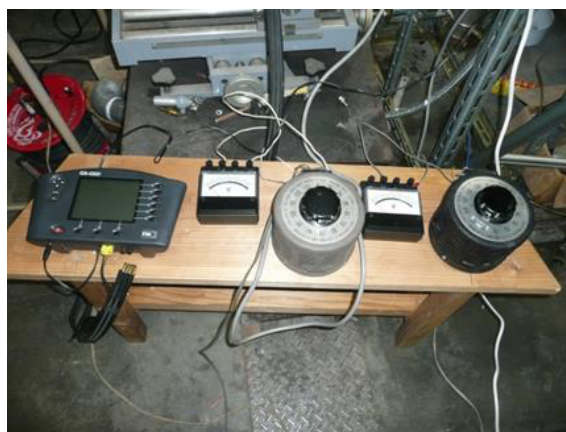
排ガス分析計・配管加温調整スライダック
