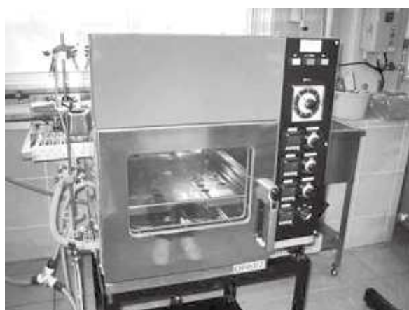
図5 過熱水蒸気発生装置付き天然有効成分抽出装置
