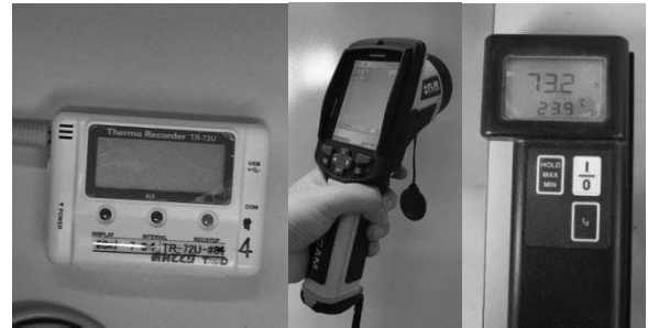
写真2 実測に使用した代表的測定機器 (左:ロガー(T&D TR-72), 中央:サーモグラフィ(FILIR BCAM), 右:温湿度モニタ(testo 610))
