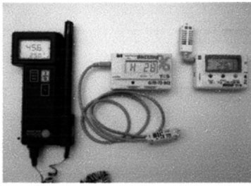
写真6 今回の実測で使用したロガー類(左から testo610, T&D TR-72, TR-72U)
