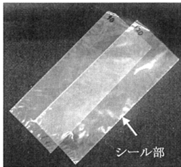
図 1 サイドシール製袋法で作られた袋の一例
