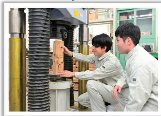
卒業研究 木材の圧縮強度実験(5年) Graduation Research (5th grade)
